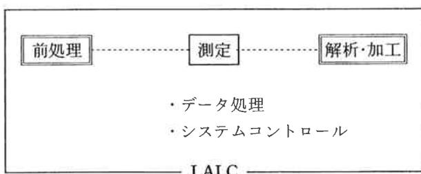
「分析」という行為は上図に示したように「前処理」「測定」「解析・データ加工」という3つの行程に分類でき、どの段階も均等に重要である。しかし分析機器の現段階でのコンピュータ利用は「測定」行程では積極的に進んでいるものの、その前後の「前処理」「データ解析」に関しては今一步の感がある。そこで、「前処理」と「解析」へのコンピュータ利用へ一步踏み込む事が次の LALC への課題であると判断した。「前処理」に関しては最近分析化学の分野で集目を集めている FIA (Flow Injection Analysis) の技術に着目し、東洋曹達独自の FIA システムを構築し FIA を LALC に取り込む事に成功するとともに、なおかつ「解析」に関してはコンピュータとして市販のオフコンを採用し OA とのリンクを高めるとともにシステムプログラムのほとんどを高級汎用言語 BASIC でプログラミし、ライブラリィ・データベース等の構築の基礎作りを行なった。
