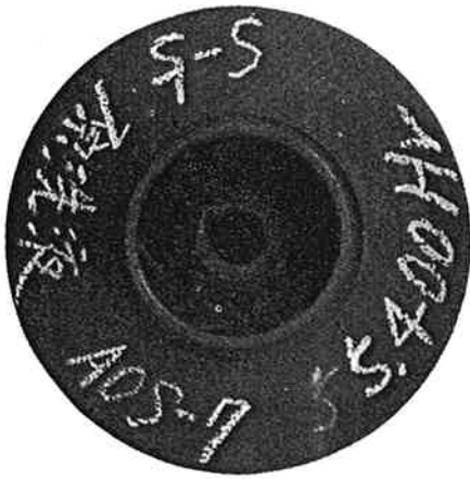
写真1 ア法工程液Iにおける 試験 No.1 ランナー
