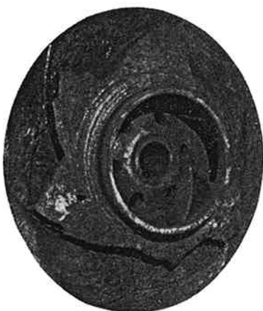
写真5 ア法工程液にて 400時間使用したFC製ランナー
