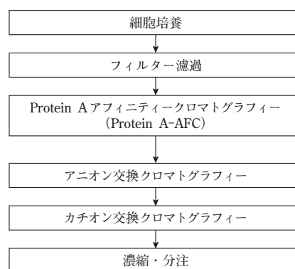
図 1 抗体医薬品の一般的な製造スキーム
