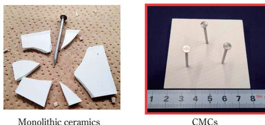
Fig. 1 Nail penetration test<sup>9</sup>
