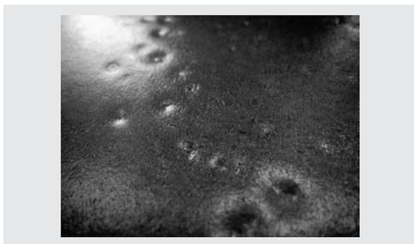
図4 両面発泡構成における非発泡層表面の外観写真
