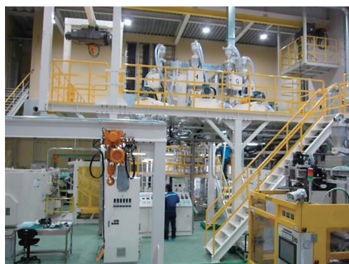
図4 9層水冷インフレーション成形装置外観
