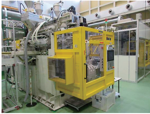
図6 多層ブロー成形装置外観
