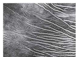
透過型電子顕微鏡による ポリエチレンナノファイバー像60000倍画像
