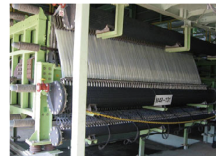
苛性ソーダの新型電解槽
