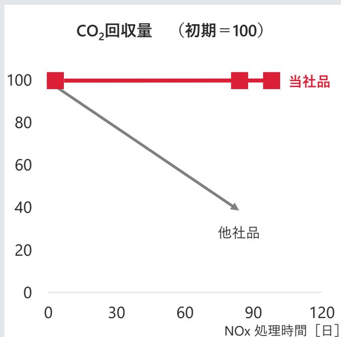
当社のアミン溶液は時間が経過してもCO<sub>2</sub>回収量は落ちない
