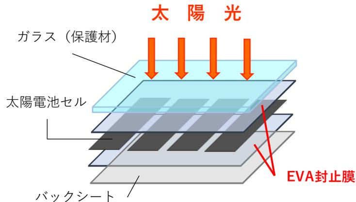
透明性・耐候性・柔軟性・接着性に優れ、太陽電池セルの封止材・保護材として機能
