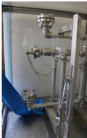
液飛散危険体感装置
