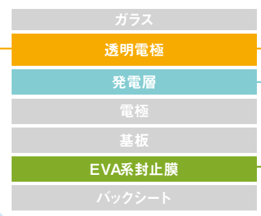
薄膜系太陽電池断面図
