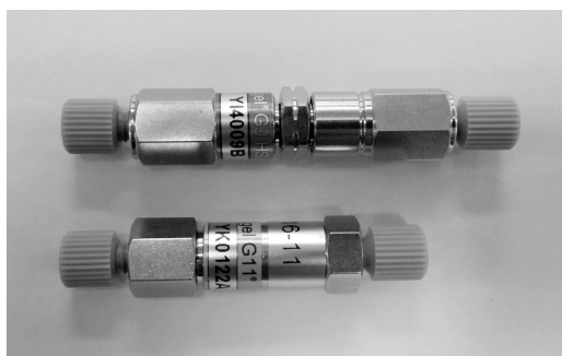
図2 TSKgel G9HSi(上)とTSKgel G11(下)のカラム外観
